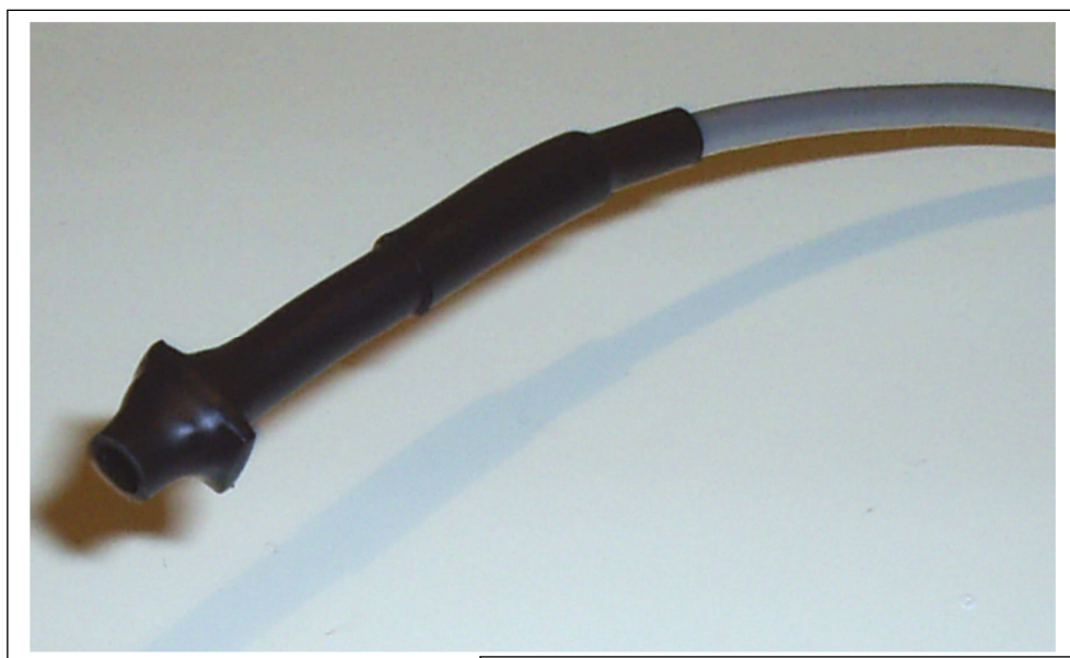
Fot.1 Izolacja czujnika SHT-11
